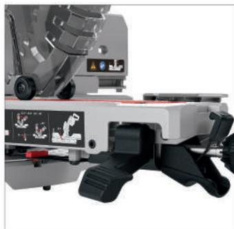
Graduation angulaire usinée au laser de 52° G / 60° D. Avec points de crantage d'angle de 0°, 15°, 22,5°, 31,6°, 45° G / 0°, 15°, 22,5°, 31,6°, 45°, 60° D. Facilement lisible et réglable avec précision grâce à des éléments de commande intuitifs
