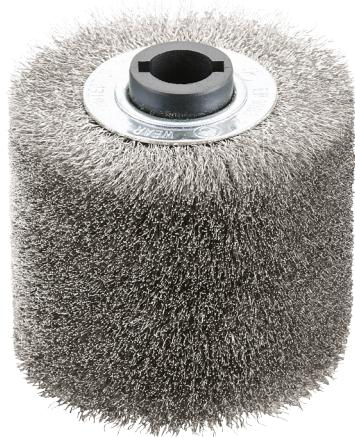
Zum Bearbeiten von Holzoberflächen mit Gerbstoffen wie Eichenhölzer und zum Strukturieren, Ausbürsten von Jahresringen in Weichhölzern. Entfernt Farbrückstände auf Holzoberflächen. Ideal auch zum Bürsten von metallischen Oberflächen. Mit 4-Nut Walzenkern, passend für alle Geräte mit 19 mm Keilnutspindel (kompatibel für LP 1503 VR).
