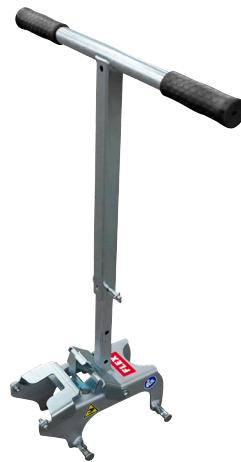
Schwere Lasten mit dem Handtragegriff und VLP 18 Grabo ergonomisch, in aufrechter Position heben. Einfach und schnell montieren, Platte heben und das Vakuum über integrierte Fußpedale lösen. Der Tragegriff ist höhenverstellbar, Tragfähigkeit bis zu 130 kg, für eine Person.
