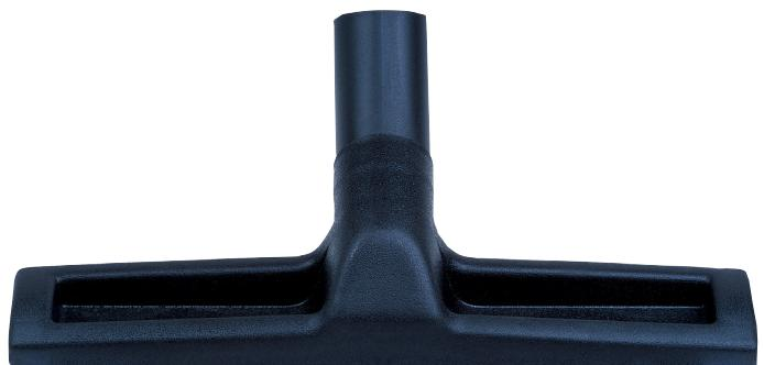
Bürsteneinsatz zur Trockenreinigung und Gummileiste zur Nassreinigung. Durchmesser 36 mm, Breite 300 mm.
