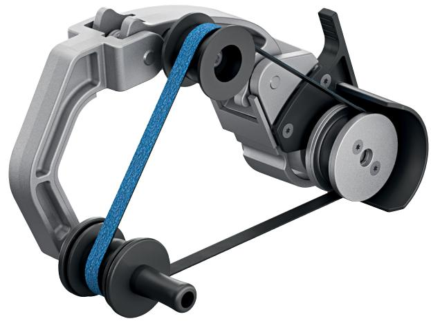
Schleifvorsatz zum Rohrbandschleifen für die TRINOXFLEX. Werkzeuglos über das Schnellwechselsystem montierbar. Vorsatz variabel verstellbar. Mit Schleifbandset ZIRCOFLEX 9 mm.
