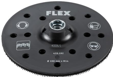
Mit 6 + 8-Loch-System zur optimalen Staubabsaugung für alle FLEX Klett-Schleifmittel Ø 150 mm. Die 3 mm Zellkautschuk-Dämpfung reduziert die Abscherkräfte zwischen Trägerteller und Schleifmittel. Durch hohe Kletthaken wird mehr Temperaturbeständigkeit bei starker Beanspruchung erreicht.
