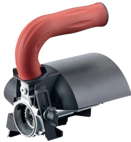
Schleifvorsatz zum Bürsten für die TRINOXFLEX. Mit abnehmbarer Schutzaube und Absauganschluss Ø 32 mm für staubarmes Arbeiten. Inklusive Führungsanschlag und vibrationsgedämpftem ergonomischen Handgriff. Werkzeugloser Schleifwerkzeugwechsel über patentiertes Schnellwechselsystem.
