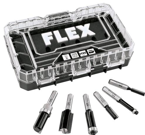
Fräser Bit-Set mit Hartmetallschneiden, verpackt in der praktischen Stack Pack Bit-Box mit Moosgummi-Einlage. Bestehend aus jeweils 1x Nutfräser D6x20 mm, Nutfräser D8x20 mm, Nutfräser D16x30 mm und jeweils 1x Bündigfräser D8x20 mm mit Anlaufkugellager D8, Bündigfräser D12,7x25 mm mit Anlaufkugellager D12,7, Bündigfräser D16x25 mm mit Anlaufkugellager oben D16.
