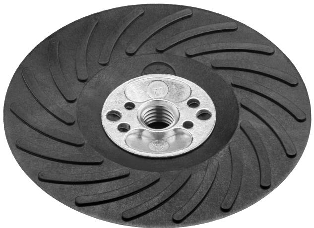
Zur Verwendung von 125 mm Fiberschleifscheiben, mit Spannmutter M14. Einsatz: zum Entgraten, Entrostern von Metallteilen sowie allgemeine grobe Schleifarbeiten. Die auf der Schleiffläche radial verlaufenden Kühlrippen verringern Überhitzung von Werkstück und Stützteller. Geeignet für alle FLEX Winkelschleifer außer L1606 VR/L1603 VR.
