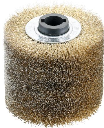
Zum Bearbeiten, Strukturieren von Holzoberflächen und Ausbürsten von Jahresringen in Weichhölzern. Entfernt Farbrückstände auf Holzoberflächen. Mit 4-Nut Walzenkern, passend für alle Geräte mit 19 mm Keilnutspindel (kompatibel für LP 1503 VR).
