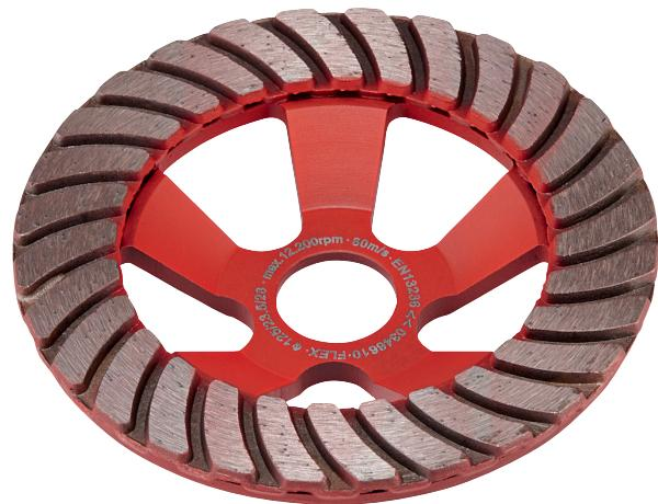
Turbo-Jet Schleifteller mit optimaler Abtragleistung. Durch die Vielzahl der Diamant-Segmente entsteht ein deutlich ruhigeres Laufverhalten und schöneres Schleifbild. Ideal für den Flächenschliff auf mineralischen Untergründen.
