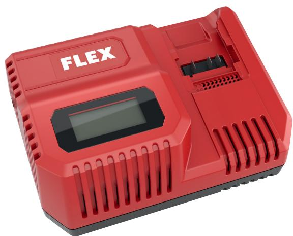
Zum Laden von 12 und 18 V Akkupacks. Mit großformatigem LCD Display für Batteriediagnostik und Ladezustand. Ladezeit 12 V/18 V : ca. 40 min. für 2,5 Ah, ca. 50 min für 5,0 Ah, ca. 75 min für 8,0 Ah/18V. Durch ein speielles Ladeverfahren werden 80% der Ladekapazität nach ca. 30 min erreicht. Mit integrierter Akkupackkühlung, Überhitzungs-, Entladungs- und Überlastschutz.
