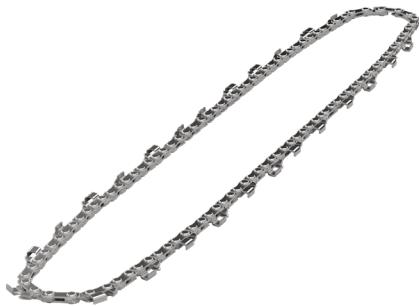
Langlebige und robuste Sägekette für Sägeschienen mit 35 cm Länge, einer Schienennutbreite von 1,1 mm und einer 3/8"-Teilung. Das hohe Schnittfestigkeitsniveau und das lange Zahndach ermöglichen häufigeres Schärfen. Ideal zum Schneiden von dünnen Baumstämmen, Kaminholz, Entasten von Hölzern.
