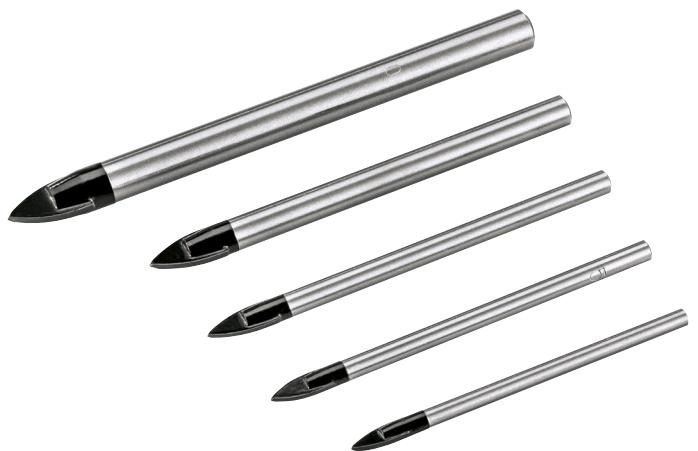
Fliesen-/Glasbohrer mit Hartmetallplatte und Spitzkegelanschliff für punktgenaues Anbohren. Beste Bohrergebnisse werden bei niedrigen Drehzahlen mit ausreichender Kühlung erzielt. Geeignet für Glas, Fliesen, Keramik, Spiegelglas und Porzellan. Inhalt je 1 Bohrer Ø 4x60, 5x70, 6x70, 8x80 und 10x100.
