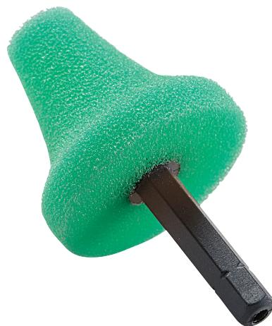
Grüner Schwamm mit harter Schaumstoffstruktur für hohen Abtrag und die Bearbeitung tieferer Kratzer. Kegelform ideal geeignet zum Polieren von Türgriffmulden, Kühlergrill, Felgen und im Innenraum. Abgerundete Kanten zur Vermeidung von Schleifriefen und praktischer Spitze zum Polieren in Ecken und Kanten. Werkzeugloser Wechsel durch 6-Kant-Bithalter-Aufnahme am Schaft. Verwendbar mit der flexiblen Welle FS 140 in Verbindung mit der Poliermaschine PXE 80 10.8-EC.
