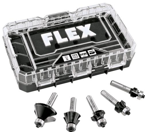
Kantenfräser Bit-Set mit Hartmetallschneiden, verpackt in der praktischen Stack Pack Bit-Box mit Moosgummi-Einlage. Bestehend aus jeweils 1x Radienfräser R2, Radienfräser R3, Radienfräser R5 mit Anlaufkugellager D12,7 und jeweils 1x Fasenfräser 25°, Fasenfräser 45° mit Anlaufkugellager D12,7.
