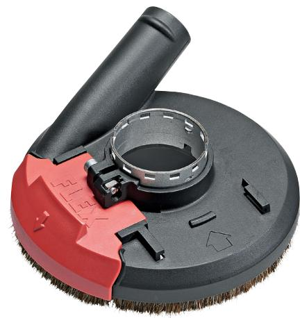
Ermöglicht randnahe Arbeiten bei höchster Absaugleistung. Höhenverstellung über Innensechskantschraube erlaubt ein schnelles Anpassen der Absaughaube auf die Werkzeughöhe. Hinweis: für das Arbeiten mit der Absaughaube und Diamantschleiftellern wird ein Winkelschleifer mit mindestens 1500 Watt empfohlen. Nur passend für Winkelschleifer mit Rastmechanik-Schutzhaube.
