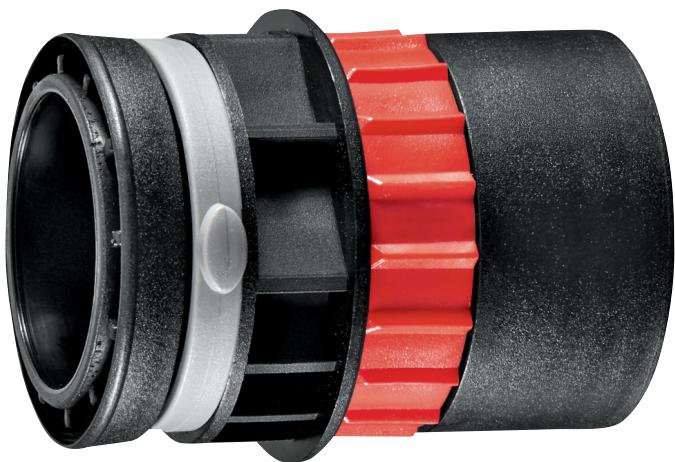
Gewindinger Durchmesser 32 mm mit Clip-Anschluss inkl. Nebenluftrregelung zur Reduzierung des Saugunterdrucks nach Bedarf, kompatibel für alle 32 mm Saugschläuche.
