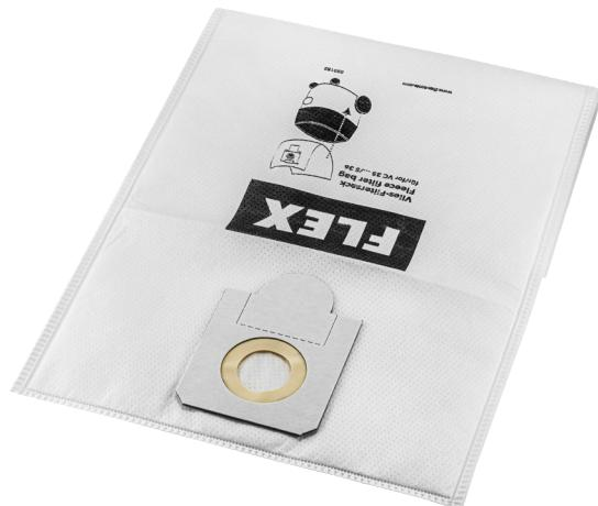
Filtersack mit FLEX VacuVlies-Technologie für VCE 35 L AC, VC 35 L MC. Doppelte Volumen-Kapazität und deutlich bessere Saugleistung im Vergleich zu Papier-Filtersack (Bestell-Nr. 296.961). Hoch reißfest durch 4-schichtiges VacuVlies-Material: bietet Schutz gegen Beschädigung durch scharfkantiges Sauggut. Resistent auch bei unbeabsichtigtem Nass-Saugen oder feuchtem Sauggut.
