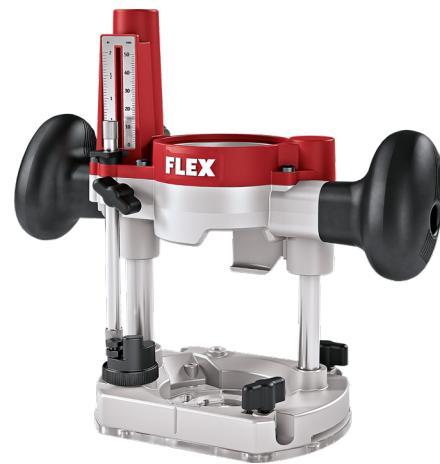
Für den Umbau zur Oberfräse, mit gummierten Griffen und Klemmfunktion für eine sichere Führung, inkl. Grundplatte. Der Fräskorb verfügt über eine Nullfunktion der Skala, Frästiefeneinstellung über Revolveranschlag sowie stufenlose Frästiefen-Feineinstellung über Drehring.
