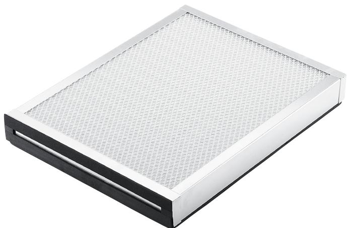
Filterkassette hält bis zu 80 % der Feinstaubpartikel zurück. Luftwiderstand nur 60 Pascal. Passend für VAC 800-EC.
