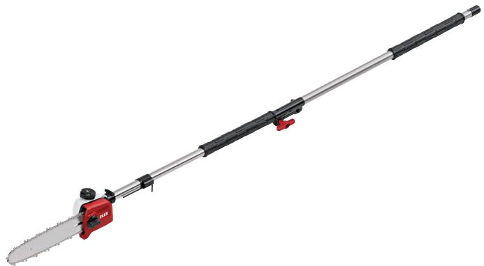
Der Hochentaster-Vorsatz inkl. 80 cm Verlängerung für den Akku-Basisantrieb erlaubt das Ablängen hoher Äste ohne Leiter. Vorsatz werkzeuglos montierbar, Mit dem 25 cm langen Schwert und einer Kettengeschwindigkeit von 13 m/s können Äste bis ca. 20 cm Durchmesser problemlos durchtrennt werden, Am Hochentaster befindet sich ein automatisches Schmiersystem mit einem Ölbehälter (120 ml), damit die Kette ungehindert weiterläuft
