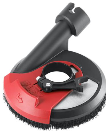
Für eine optimale Staubabsaugung ohne Adapter. Ermöglicht randnahes Arbeiten bei höchster Absaugleistung. Werkzeuglose Höhenverstellung über Spannhebel erlaubt ein schnelles Anpassen der Absaughaube auf die Werkzeughöhe.
