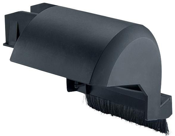
Absaughaube für die BSE 14-3 100 mit Absauganschluss (Clip D32) für Walzen und Bürsten mit max. Ø 110 mm.
