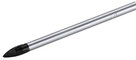
Fliesen-/Glasbohrer mit Hartmetallplatte und Spitzkegelanschliff für punktgenaues Anbohren. Beste Bohrergebnisse werden bei niedrigen Drehzahlen mit ausreichender Kühlung erzielt. Geeignet für Glas, Fliesen, Keramik, Spiegelglas und Porzellan.
