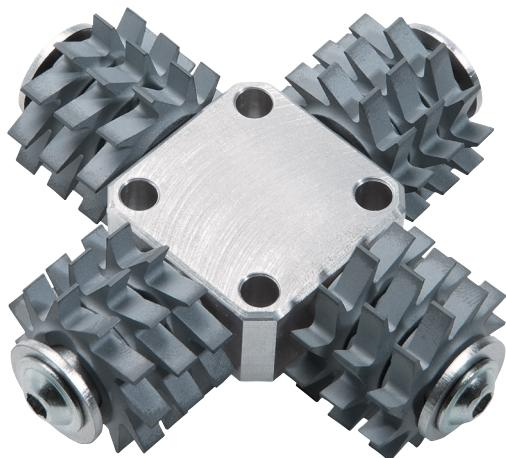
Bestückt mit 12 flachen Hartmetall Fräsrädern. Zum Entfernen von weichen Materialien wie Putz, frischen (grünen) Beton, Schaumrücken und Kleberresten, weichen PU-Beschichtungen, Farbanstrichen auf Putz, Putz auf Holzbalken und Latex-/Ölfarben auf Putz, Schalungsübergängen und Betonläufen an frisch betonierten Flächen. Der Untergrund wird durch die flache Form (ziehender Schnitt) glatt.
