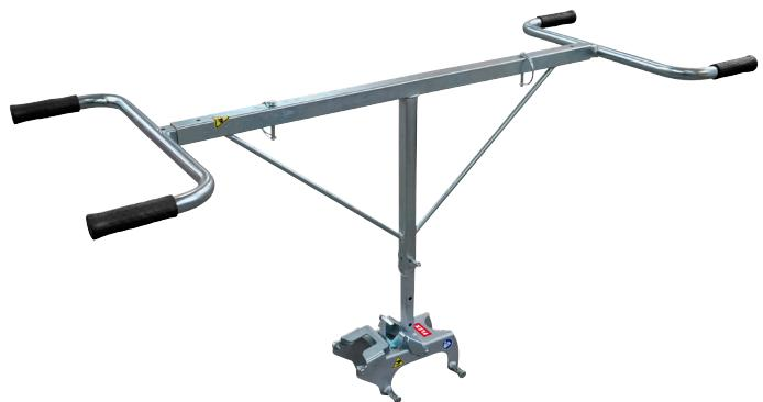
Schwere Lasten mit dem Handtragegriff und VLP 18 Grabo ergonomisch, in aufrechter Position heben. Einfach und schnell montieren, Platte heben und das Vakuum über integrierte Fußpedale lösen. Der Tragegriff ist höhenverstellbar, Tragfähigkeit bis zu 130 kg, für zwei Personen.
