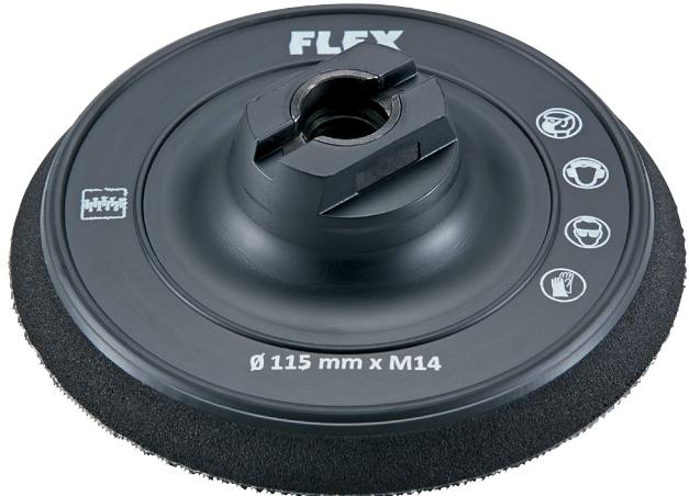
Schleifteller mit Klettbelag Bowl zur Befestigung der Schleifmittel mit Klett-System. 12 mm Zellkautschuk sorgen als Dämpfungselement für eine gleichmäßige Druckverteilung.
