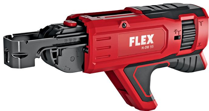
Für handelsübliche, gegurtete Schrauben. Schraubmagazinvorsatz 360° drehbar, gute Eckenerreichbarkeit, werkzeuglose Schraubtiefeneinstellung über Drehrad, werkzeuglos verstellbarer Tiefenanschlag zur Anpassung der unterschiedlichen Schraubenlängen von 25-55 mm, max. Schaftdurchmesser 4,2 mm. Ergonomische Softgrip Griffflächen. Passend für den Trockenbauschrauber DW 45 18.0-EC.
