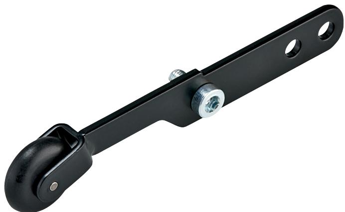
Für Winkel und enge Stellen. Anwendungsfälle: Keilnähte verschleifen (großer Radius), Kanten entgraten, Treppengeländer schleifen, Nut-Zwischenräume bei Nut- und Federbrettern schleifen. Schleifarm verstellbar für Bandlängen 520 mm und 533 mm.
