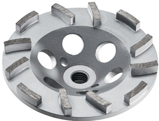
Schleifteller geeignet zum Abschleifen von Betonteilen, Anschleifen von verwittertem Altbeton, hartem Zementputz, zum Entfernen von Schalungsübergängen und Betonläufern, ausgehärteten Epoxidharzbeschichtungen und der Sinterschicht an Betonteilen. Hohe Schleifleistung und Lebensdauer durch neuartige Segmentkonstruktion. Optimale Untergrundvorbereitung für eine weitere Beschichtung.
