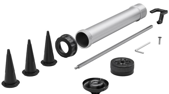
Auspressrohr für 600 ml Folienbeutel. Set bestehend aus Auspressrohr 600, Stange 498 mm, Druckstück Folienbeutel, Druckstück Eimermaterial, Düsenkappe, Haken, Innensechskantschlüssel und 3 Düsen.
