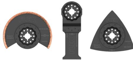
Mit Starlock-Aufnahme für optimale Kraftübertragung und bequemen Blattwechsel. Für erhöhte Verschleißfestigkeit sind die Schneidekanten mit Carbide besetzt. Optimal für den Sanitärbereich z.B. zum Entfernen von Fliesenfugen, Absägen von Kupferrohren. Inhalt: 1 Hartmetall Dünnschliff-Segmentklinge, 85 mm, 1 Hartmetall Delta-Klinge, 78 mm, 1 BIM Stechschnitt-Sägeblatt Metall, 32 x 50 mm.
