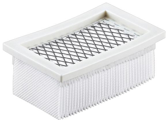
Flachfaltenfilter aus Papier der Klasse H/HEPA 13. Aus speziellem Material mit einem Durchlassgrad von < 0,005%. Schmutzabweisende Oberfläche und hohe Standzeit.
