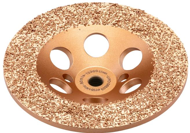
Hartmetallschleifteller mit aufgelöteten Hartmetallschneiden. Zum Abschleifen von weichem Putz, Entfernen von Farbanstrichen und Fliesenkleber auf weichem Putz, Fugen- und Spachtelmassen, gealterten Ausgleichs- und Spachtelmassen sowie zum Anschleifen von Fliesenkleber auf weichem Putz.
