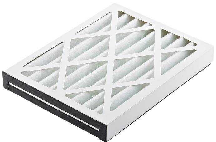
Grobstaub Filterkassette zum Einsatz als Vorfilter. Hält bis zu 90 % der Staubpartikel zurück. Luftwiderstand nur 45 Pascal. Passend für VAC 800-EC.
