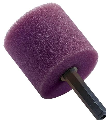
Violetter Schwamm mit mittelharter Schaumstoffstruktur für mittlere bis feine Kratzerentfernung. Zylinderform ideal geeignet für schmale Leisten und Spotrepair. Werkzeugloser Wechsel durch 6-Kant-Bithalter-Aufnahme am Schaft. Verwendbar mit der flexiblen Welle FS 140 in Verbindung mit der Poliermaschine PXE 80 10.8-EC.
