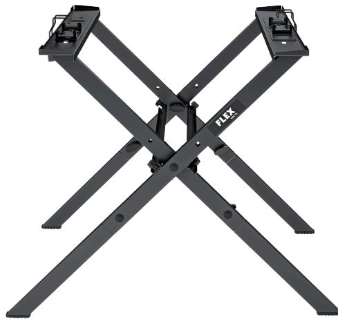
Leichtes und stabiles Untergestell mit komfortabler Arbeitshöhe von 922 oder 942 mm, für den Transport zusammenklappbar. Die Akku-Tischkreissäge lässt sich werkzeuglos durch Klammern vorne und hinten befestigen. Mit Endkappen für einen sicheren Stand und als Schutz vor Kratzern.
