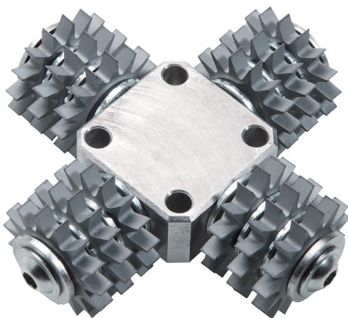
Bestückt mit 12 spitzen Hartmetall Fräsrädern. Zum Entfernen von hartem Putz, Beton, Schaumrücken und Kleberresten, Farbanstrichen auf Putz, Kunstharzputz, elastischen Schutzanstrichen, Putz auf Holzbalken und Latex-/Ölfarben auf Putz. Der Untergrund wird durch die spitze Form aufgeraut.
