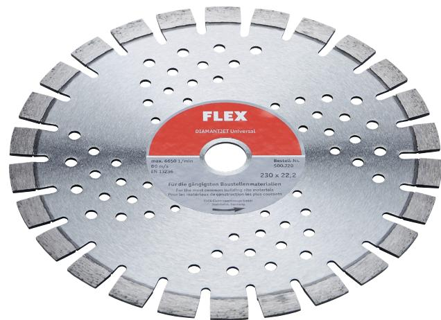
Universaltrennscheibe für die gängigsten Baustellenmaterialien wie z.B. Beton B45 (harter Beton), weiche Granite, Klinker, Ziegel.
