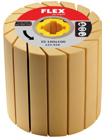
Zur Verwendung von Schleif- und Polierhülsen. Diese werden einfach über den Gummiträger geschoben und durch die Fliehkraft sicher gespannt.
