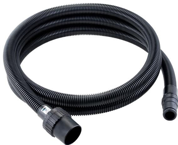
Innen-Ø 27 mm, 3,5 m mit flexibler Gummi-Mülle für den Anschluss an Elektrowerkzeuge, antistatisch. Passend für alle Sauger der VCE 33 und 44 Klasse sowie für VC 21 und VCE 22, 26.
