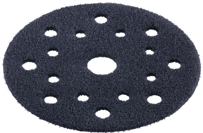
Zum Schutz von Klett-Schleifteller/Klett-Schleifplatte und Klettbelag. Die Schutzauflage wird per Klettverschluss direkt auf den Schleifteller/Schleifplatte unter dem Schleifpapier befestigt und verlängert somit die Standzeit von Schleifteller/Schleifplatte und den Kletthaken.
