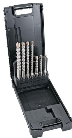
7-teiliges Set mit 4 Schneiden, bestehend aus Hammerbohrern 5 Ø / 6 Ø / 8 Ø x 110 mm, 6 Ø / 8 Ø / 10 Ø / 12 Ø x 160 mm. Ideal für extreme Anwendungen wie Bohren in Beton und Armierung.
