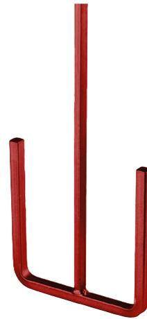
Aufgrund seiner Hakenform für sehr zähfließende Materialien mit hoher Anhaftung geeignet. Die parallele Mischwirkung verhindert Klumpenbildung und das Einrühren von Luft. Ideal für Bitumen und bitumenartige, faserhaltige Massen. Belastbar und langlebig durch Pulverbeschichtung.
