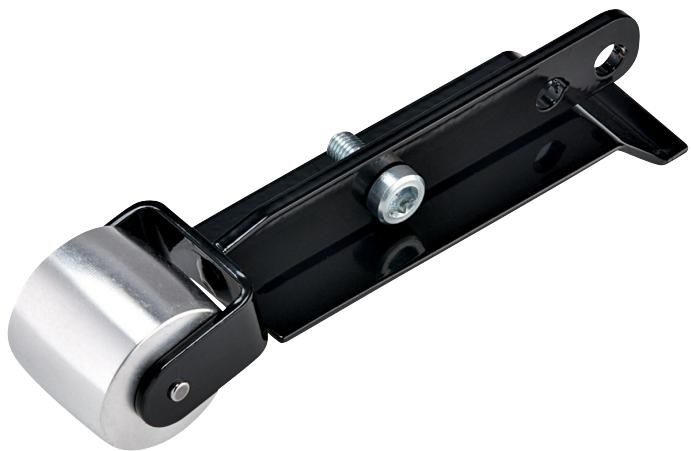
Für Rohre und Rundungen. Anwendungsfälle: Schweißnähte an Rohren verschleifen, Radien und Übergänge verschleifen, entgraten. Schleifarm verstellbar für Bandlängen 520 mm und 533 mm.
