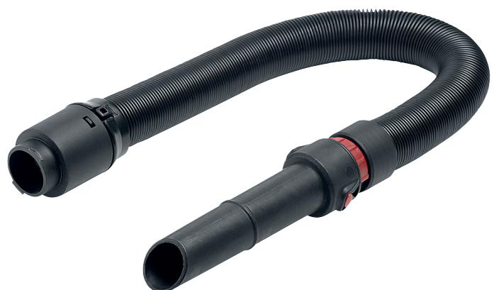
Saugschlauch mit einer Länge von 0,5 m ausziehbar bis 2,5 m. Innen-Ø 32 mm mit Universal-Geräteanschluss, Handrohr, Clip-System, inkl. Nebenluftregelung zur Reduzierung des Saugunterdrucks nach Bedarf.
