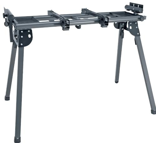
Universal Untergestell für Kapp-Zugsäge. Beidseitig ausziehbar von 1170-2600 mm, mit einem justierbaren Ausgleichsfuß. Höhenverstellbare Werkstückauflage mit Sägeanschlag, Werkzeugablagen links/rechts und Montageplatten mit Schnellspanner. Arbeitshöhe 930-1000 mm und einer Tragkraft von 400 kg. Für den Transport werkzeuglos zusammenklappbar, mit Tragegriff.
